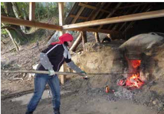
今回製作した白炭窯にて最初の炭の掻きだし作業
