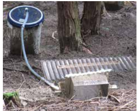
林床に設置された土砂受け箱と表面流を貯めるためのペール缶の様子
