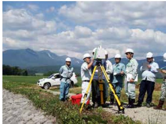
布部川の溪床を地上LIDARでスキャニング
