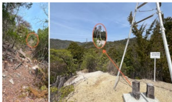
測量点間の見通し確保に向けた支障木伐採場所（左）と確保された見通し（右）
