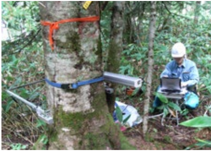
写真1 γ線を用いた生立木腐朽の非破壊診断
