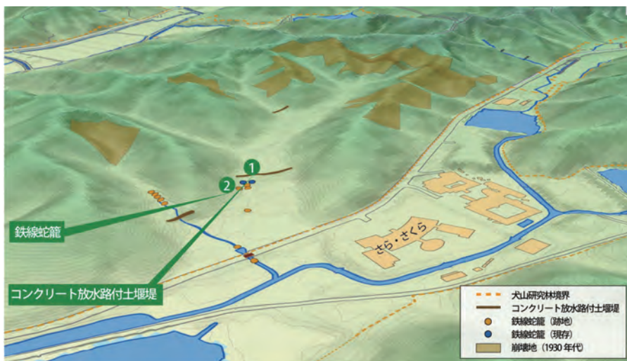
図4 溪間工事建造物群位置図 認定対象：コンクリート放水路付土堰堤、鉄線蛇籠堰堤×17、土堰堤、橋梁×2（跡地含む）
