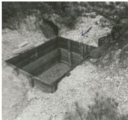
図-3 S.33.6.30 南山 崩壊地の浸蝕による土砂流出量測定柵
