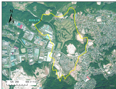
図-16 2004年の数成量水堰集水域 2004年10月22日撮影、国土地理院の空中写真をもとに作成。黄色で示す集水域は概略。
