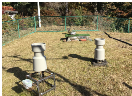
図－21 現在の白坂気象観測露場での降水量の 観測
