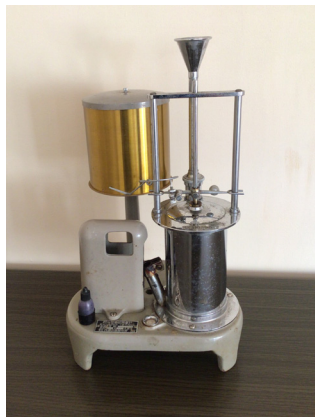
図－19 残存するサイフォン式自記雨量計の内部 機器位計測ロガー
