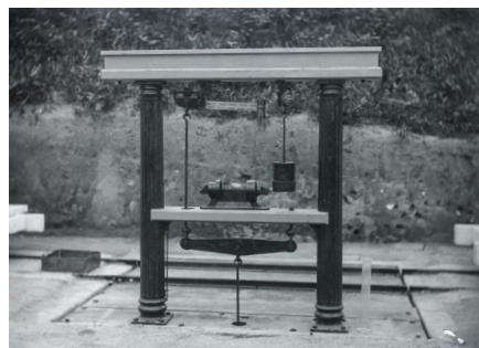
図－21 植木鉢の重量を測定した天秤 ガラス乾板写真（生水研所有）撮影時期は不明。
