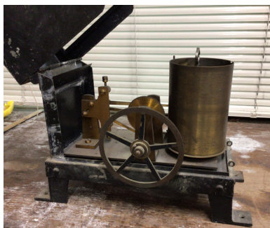
図-13 残存する当時の自記水位計
