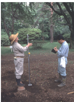
図2 長谷川式土壌硬度計で地下20cmに達するまでに要した打込み回数の平均値(各4ヶ所)
