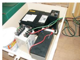
自動記録計の最も多い欠測の原因は落雷である。水晶式水位計は初めから落雷対応装置が付属してあるが、シャトルロガーは落雷対応が不完全であり、欠測がしばしばみられた。左の写真は、シャトルロガーに後付けした落雷回避装置である。
