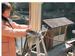
量水小屋（水位計測小屋）の近くにある雨量計
