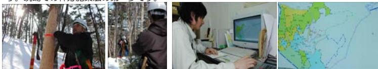
林分の境界線に目印のテープを巻いて行きます。森林を総合的に判断する経験が必要です。 林分の範囲を測定します。 パソコンに測量データを入力してGISで施業図ができます。
