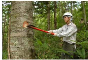
「マサカリ」は伐る木を選びます。樹皮の一部剥がして、マサカリの背の部分で打診します。響く音で木の内部の腐れや材の状態が分かります。
