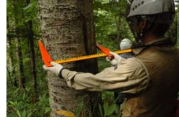
「輪尺(りんじゃく)」は胸高直径を計ります。マサカリの打診の音や外見から、材の状態(腐れ)を判断し、野帳に伝えます。
