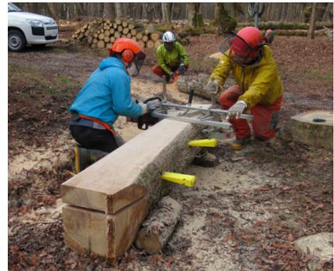
簡易製材機でミズナラの製材
