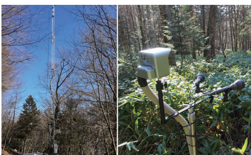
写真4 林内に設置したライブ映像音声配信システム
