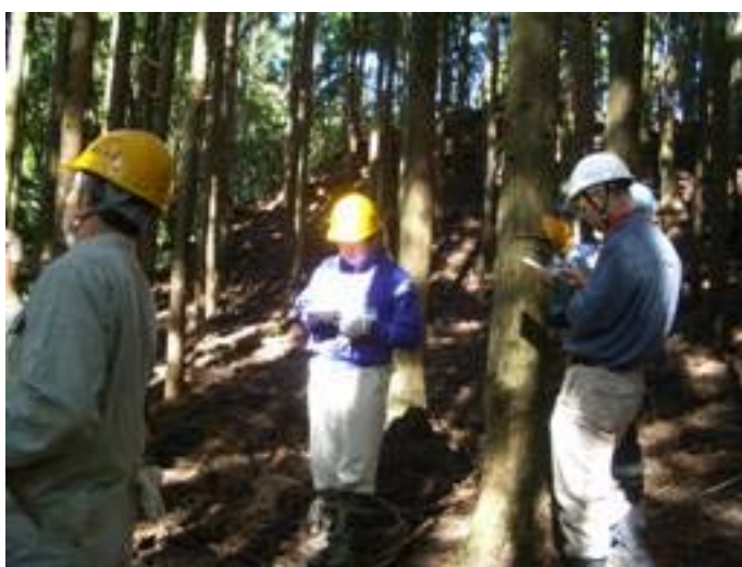
輪尺を使って胸高直径の測定
